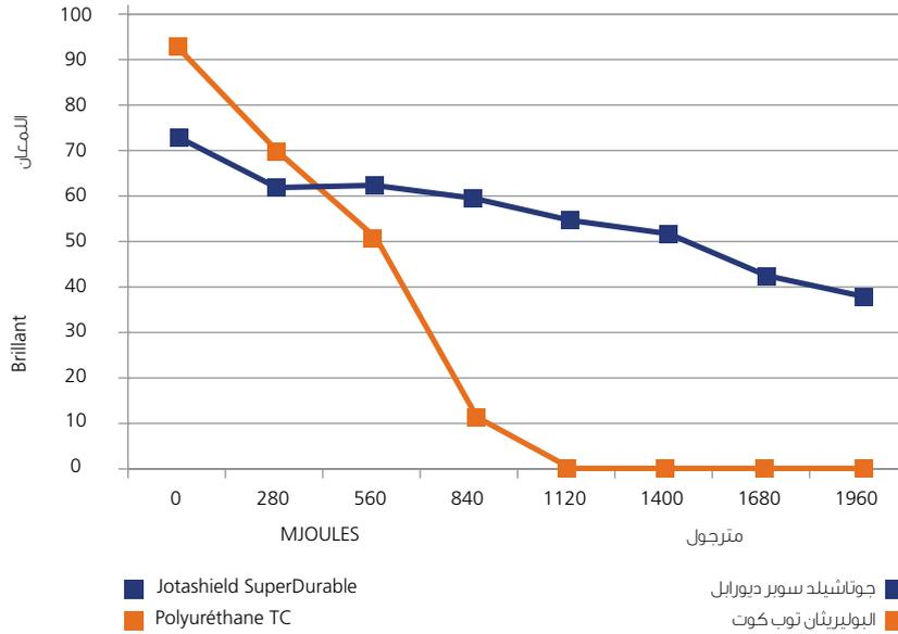
(يظهر اختبار EMMAQUA للاحتفاظ باللمعان (8 أضعاف تأثير الشمس) أداء "جوتاشيلد سوپر دورابل" مقابل مادة البولي يوريثين، والتي يبلغ متوسط عمرها المتوقع 10 سنوات) (EMMAQUA test de rétention de brillance (8 fois l'effet du soleil) montre la performance de Jotashield SuperDurable par rapport au Polyuréthane, qui a une espérance de vie moyenne de 10 années.)
